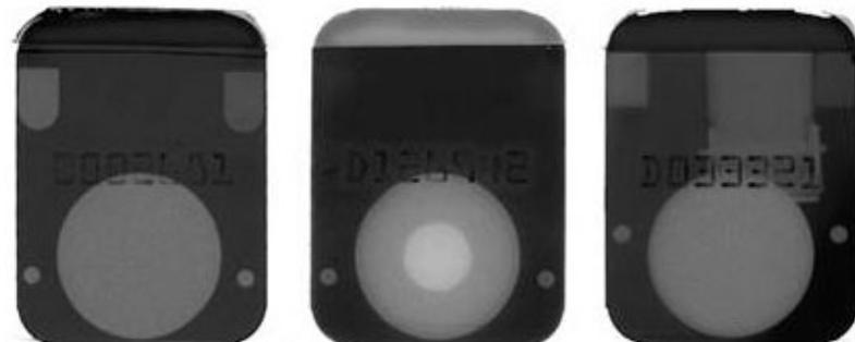
Eine qualitative Anzeige von **radioaktiven Kontaminationen** ist ebenso feststellbar. Dies ist insbesondere beim Umgang mit umschlossenen radioaktiven Stoffen wichtig, da somit eine Erkennung von Undichtigkeiten per Dosimeter möglich wird. Bei anderen Dosimetern, die keine Erkennung radioaktiver Kontaminationen ermöglichen, führt diese Nicht-Erkennung zu falschen - i.A. überhöhten - Dosiswerten.
